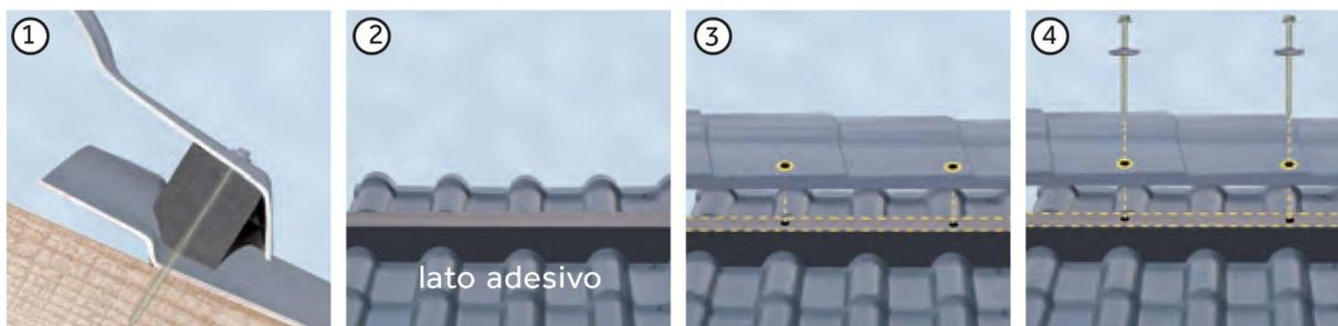
**ATTENZIONE:** per ottimizzare la tenuta d'acqua il foro deve essere effettuato in corrispondenza della parte superiore dell'onda della lastra e in mezzo alla guarnizione (fig. 3).
