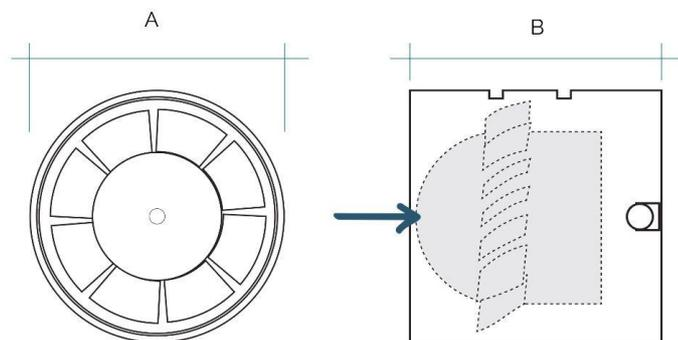
Aspiratore elicoidale cilindrico per installazione all'interno di tubi rigidi o flessibili. Può essere raccordato al tubo Ø100 mm della canalizzazione tramite giunto (cod. articolo CG100B)
